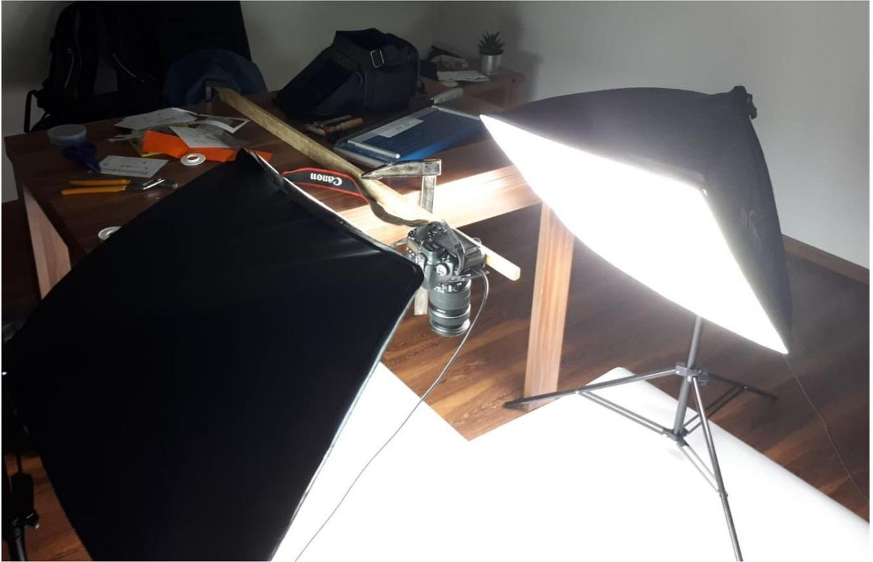
**Abbildung 1:** Finaler Aufbau für den Lernvideodreh. Links und rechts befinden sich die zwei Softboxes (Lichtquelle). Die Kamera (Canon 60D) wurde mithilfe eines eigens angefertigten Stativs über der weißen PVC Platte (Hintergrund) positioniert.
